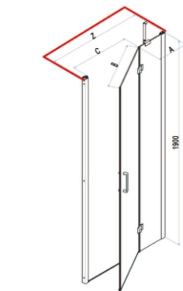
Porta ad un'anta battente, una parete fissa e una battente apribile verso l'esterno.
